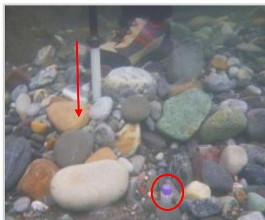
*Mise en place des tubes PVC et illustration d'un tube enfoui, fermé par un bouchon*
