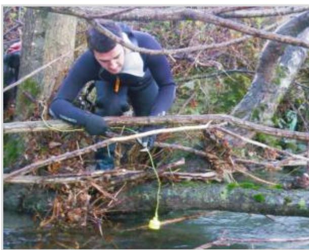
*Mise en place d'un thermographe*
