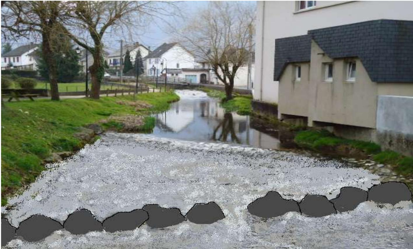
➔ **Pré-barrage avec échancrure, permet de rediriger les écoulements et diminue la hauteur de chute**
