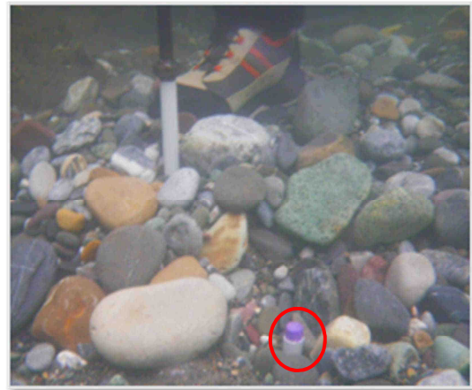
Figure 3 : implantation des tubes PVC et illustration d'un tube en place fermé par un bouchon (cercle rouge)
