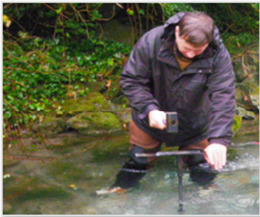
Figure 3 : implantation des tubes PVC et illustration d'un tube en place fermé par un bouchon (cercle rouge)
