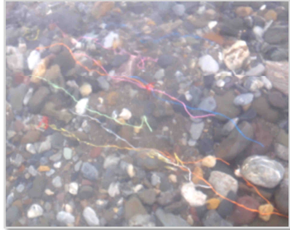
Figure 8 : vue des capsules en place (les guides PVC ont été retirés, seuls les fils colorés dépassent de la frayère)
