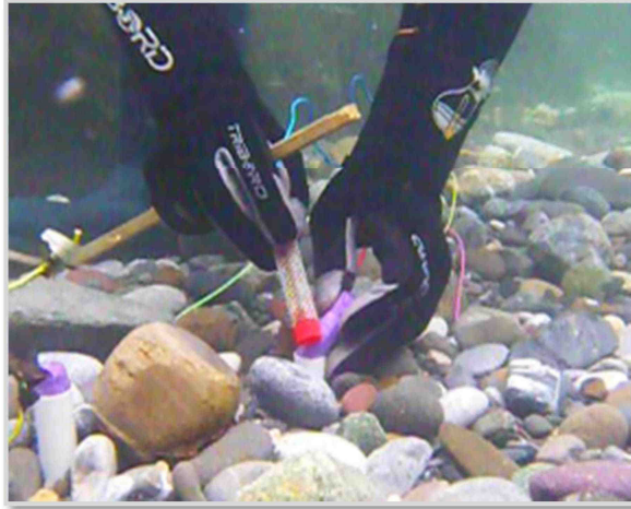
Figure 9 : implantation d'une capsule d'incubation dans le tube PVC
